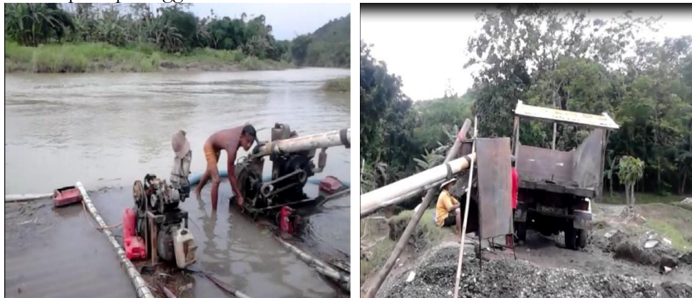
Gambar 2. Aktivitas Penambangan Pasir yang Menggunakan Mesin Diesel
